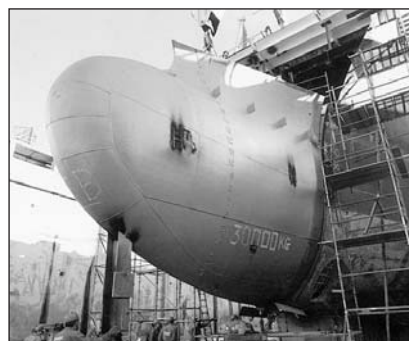
Пример использования системы Tribon при замене поврежденной в результате аварии носовой оконечности танкера-химовоза на голландской верфи Verolme Botlek (Tribon Solutions. Newsletter. N 40, 41. Фото Voets & Van Leeuwen).
