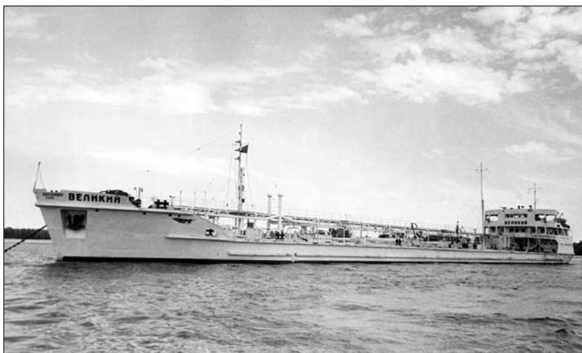
Речной танкер «Великий» грузоподъемностью 5000 т (1963 г.) типа «Волгонепфь» (серия 1963—1968 гг.)
