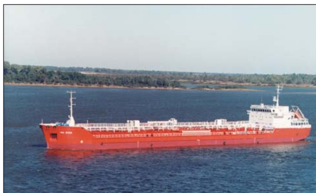
Танкер-продуктовоз «Usa river» дедвейтом 6600 т (2000 г.)
