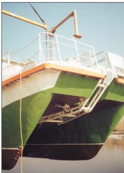
Новая оконечность природоохранного катамарана «Академик Никита Моисеев» во время спуска с помощью двух автомобильных кранов на ОАО «Морской завод "Алмаз"»
