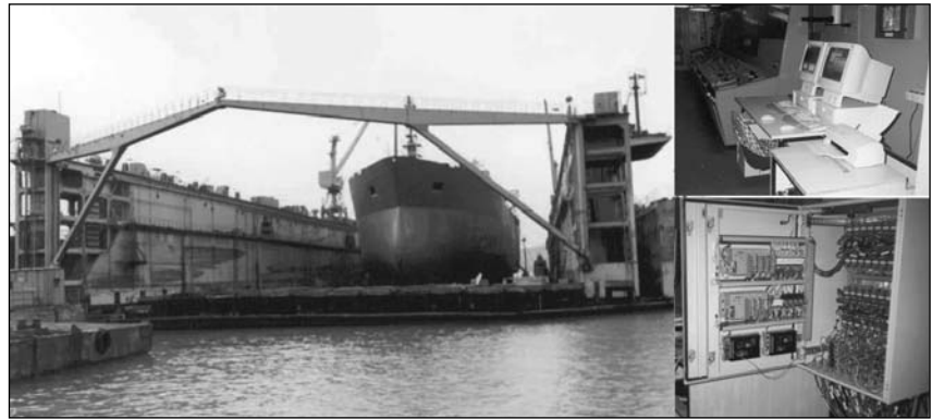
Рис. 3. Плавучий док грузоподъемностью 60 000 т, операторские станции, блок датчиков и процессоров
