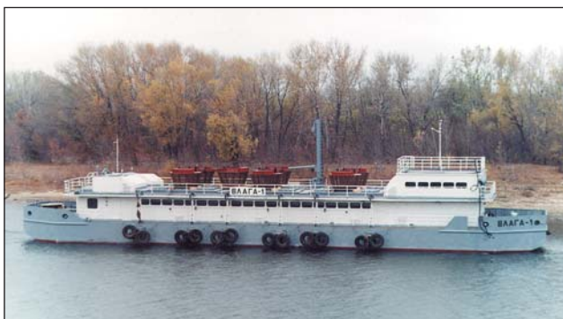
Плавучая насосная станция «Влага-1» и ее насосное отделение (ОАО «Волгоградский судостроительный завод»)
