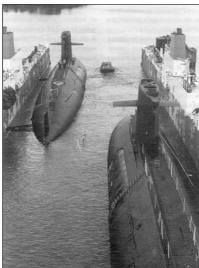
Голландские подводные лодки во время ввода на грузовую палубу полупогружного судна «Smit Exploreg» на верфи RDM в Роттердаме для транспортировки в Малайзию
