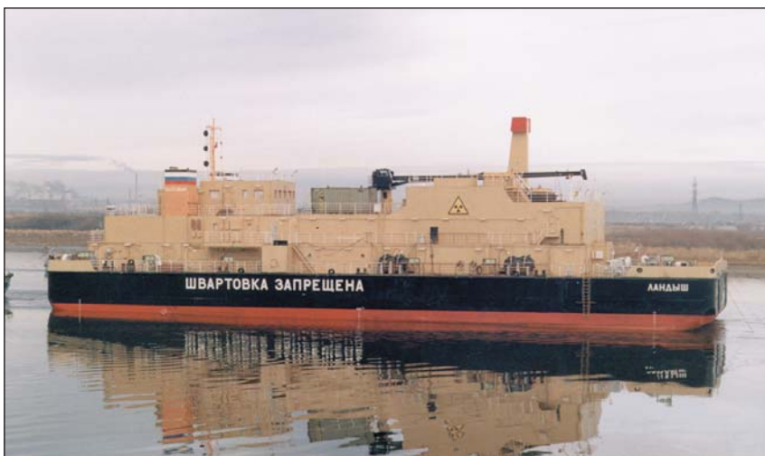
Плавучий завод «Ландыш» (пр. 00500) по переработке жидких радиоактивных отходов
