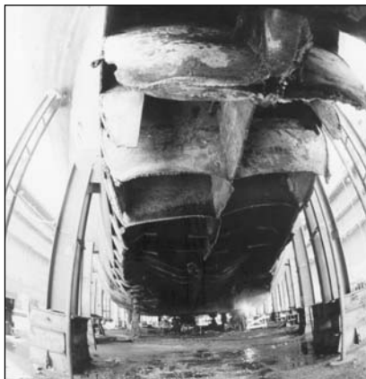
Рис. 2. Судно «Кгева» с демонтированной обшивкой днища на временных опорах (снимок панорамный, поэтому опоры искажены; часть кильблоков в оконечности еще не удалена)
