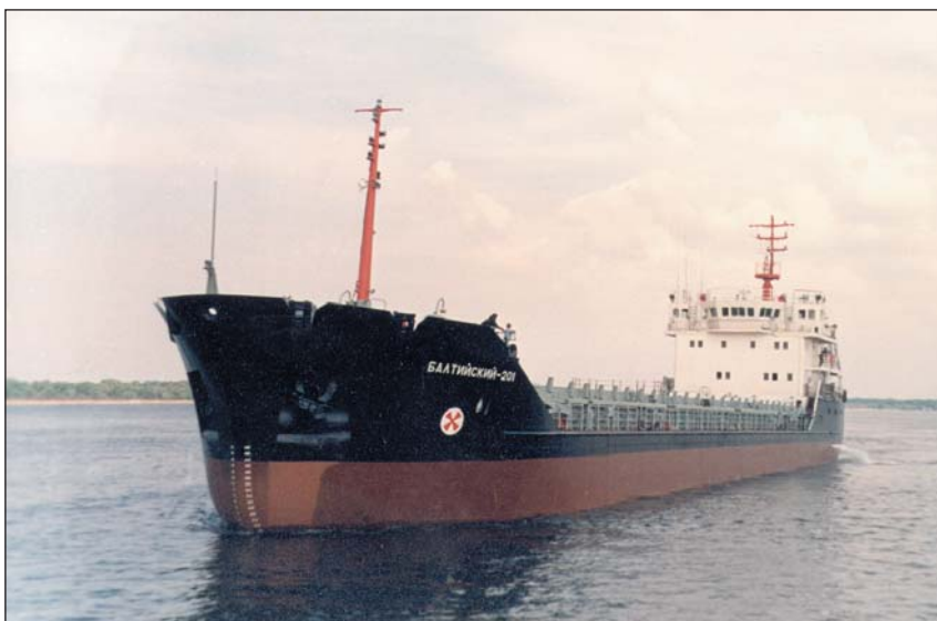
Универсальное «море—река» сухогрузное судно «Балтийский-201» дедвейтом 3350 т неограниченного района плавания (1994 г.)
