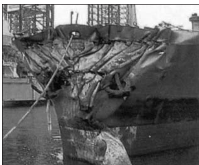
Пример использования системы Tribon при замене поврежденной в результате аварии носовой оконечности танкера-химовоза на голландской верфи Verolme Botlek (Tribon Solutions. Newsletter. N 40, 41. Фото Voets & Van Leeuwen).
