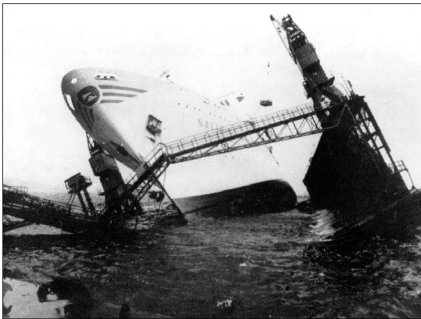
Рис. 3. Авария плавучего дока с судном в результате навала
