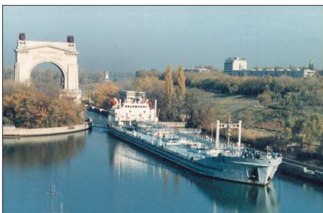
Танкер смешанного плавания грузоподъемностью 5000 т (типа «Волгонефть», серия 1967—1979 гг.)
