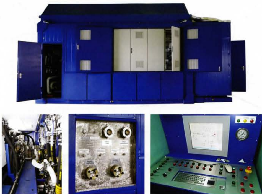
Рис. 4. Стенд для испытаний систем гидравлики Q48 а – вид спереди; б – панель распределительного щита; в – средний ярус модуля «Насосная»; г – пульт управления
