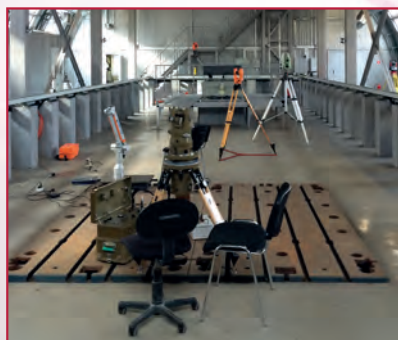
Рис. 2 Сборочная плита для контроля крупногабаритных объектов
