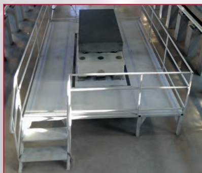
Рис. 3 Стенд эталонирования с виброустойчивым фундаментом
