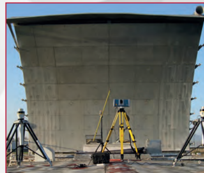
Рис. 5 Измерение объектов радиоастрономии в реальных условиях под открытым небом при солнечной засветке
