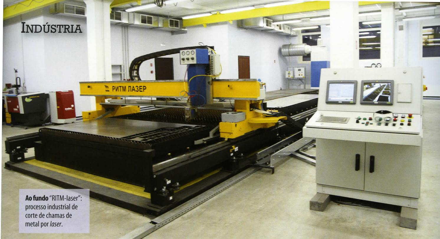
Ao fundo "RITM-laser": processo industrial de corte de chapas de metal por *laser*.
