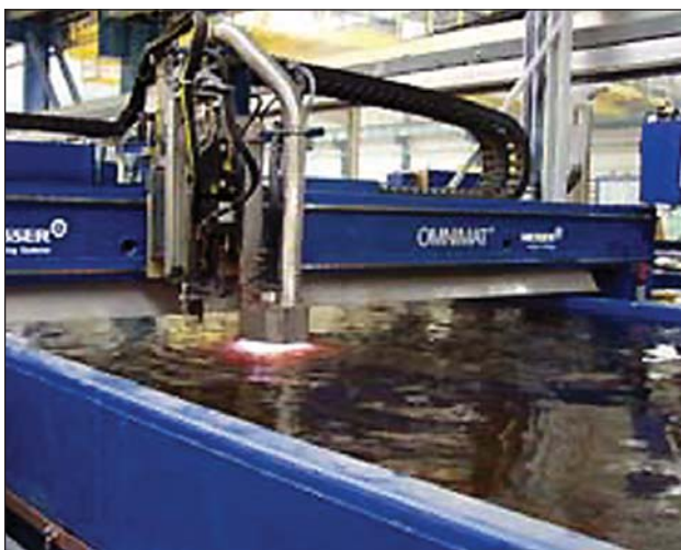
Резка стального листа в ванне с водой на новом оборудовании
