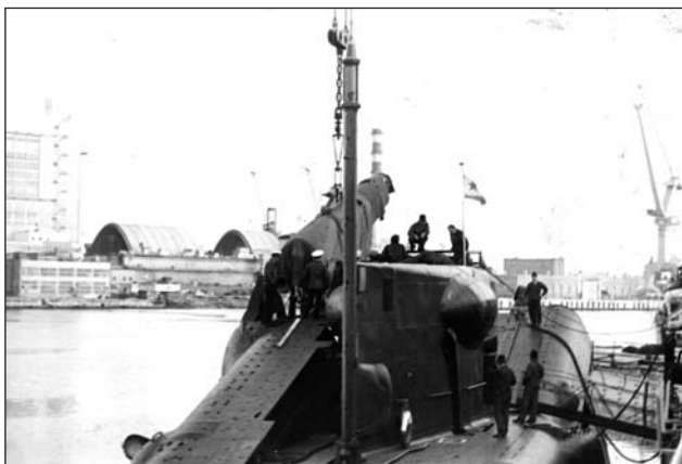
Погрузка крылатой ракеты на АПЛ К-1 (зав. № 535), переоборудованную МП «Звездочка» по пр. 675 МКВ. 12 июня 1985 г. Главный конструктор И. Л. Баранов
