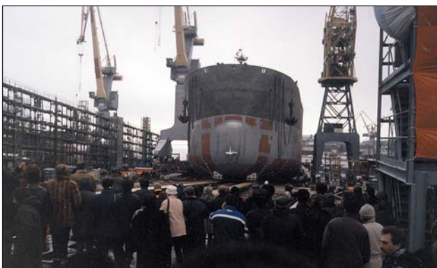
Задержник разрезан — судно движется по спусковым дорожкам
