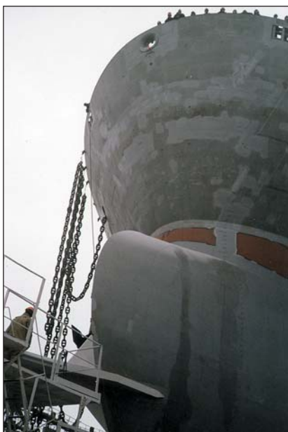
Только стальной задержник удерживает танкер-продуктовоз «Троицкий мост» на наклонном стапеле ФГУП «Адмиралтейские верфи»
