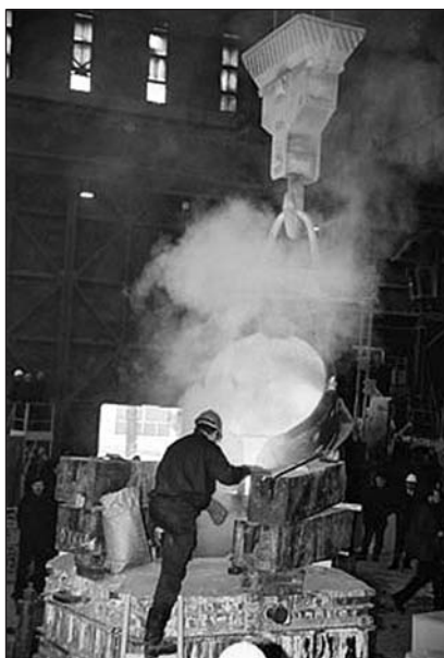
Отливка праздничного колокола для Казанского собора в цехе гребных винтов ОАО «Балтийский завод»
