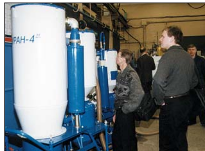
Дробеструйные аппараты типа «Буран» для беспыльной очистки поверхностей от окалины, ржавчины, старой краски
