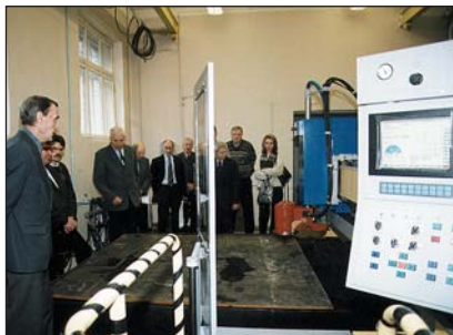
Машина «Ритм-М» для плазменной и кислородной вырезки деталей из листового металлопроката
