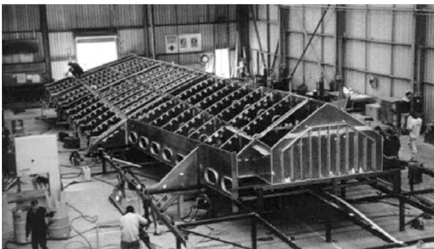
Рис. 8. Каркасный метод сборки корпуса судна за рубежом
