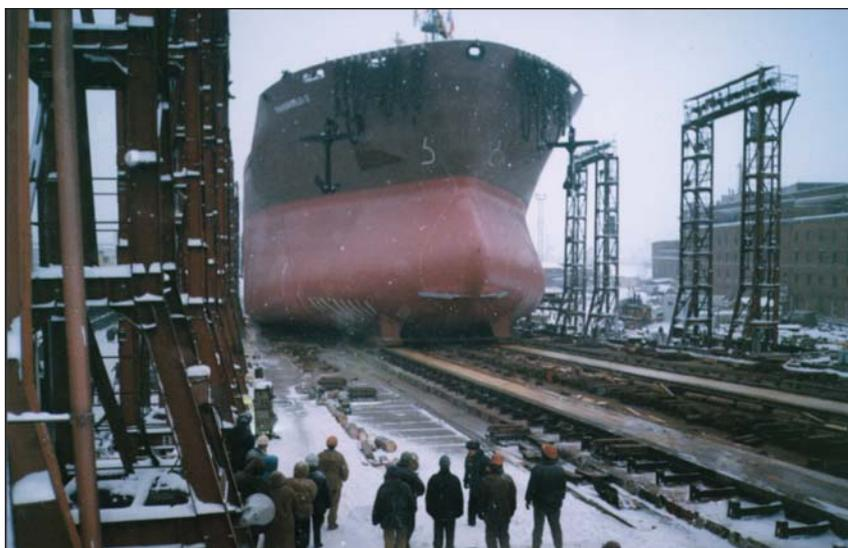
Балкер дедвейтом 48 000 т пр. 93104 в момент спуска со стапеля ОАО «Балтийский завод»
