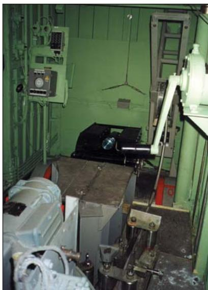
Помещение с оборудованием для спуска/подъема между корпусами катамарана «Россия» буксируемой системы
