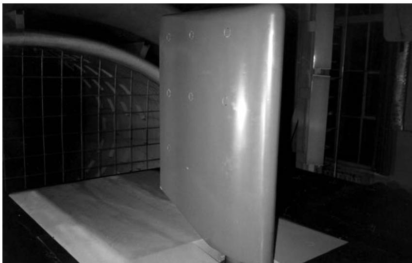
Рис. 1. Фрагмент испытаний модели руля в аэротрубе
