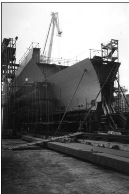
Формирование корпуса экспортного фрегата на стапеле ОАО «Балтийский завод»
