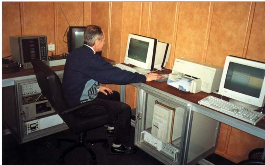
Вычислительный комплекс на борту «Россия» обеспечивает обработку, документирование и хранение поступающей экологической информации, а также подготовку электронных карт с индикацией маршрута движения судна, отметок о наличии веществ-загрязнителей и точек отбора проб
