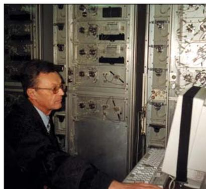
Гидрохимическая лаборатория катамарана «Россия» обеспечивает экспресс-анализ в проточном режиме содержания основных веществ-загрязнителей в непрерывно подаваемых пробах воды
