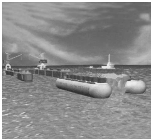
Рис. 3. Заход в плавдок катамарана с ледяным массивом, внутри которого находится судно с отравляющими веществами
