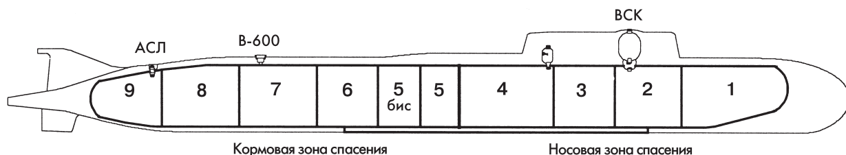
Рис. 1. Продольный разрез АПЛ «Курск» («Судостроение», 2000, № 6): ВСК — всплывающая спасательная камера; АСЛ — аварийно-спасательный люк; В-600 — автономный всплывающий буй
