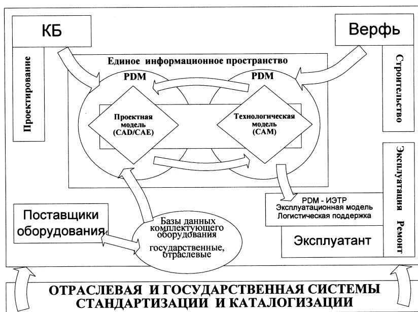
Рис. 3. Упрощенная схема взаимодействия через PDM
