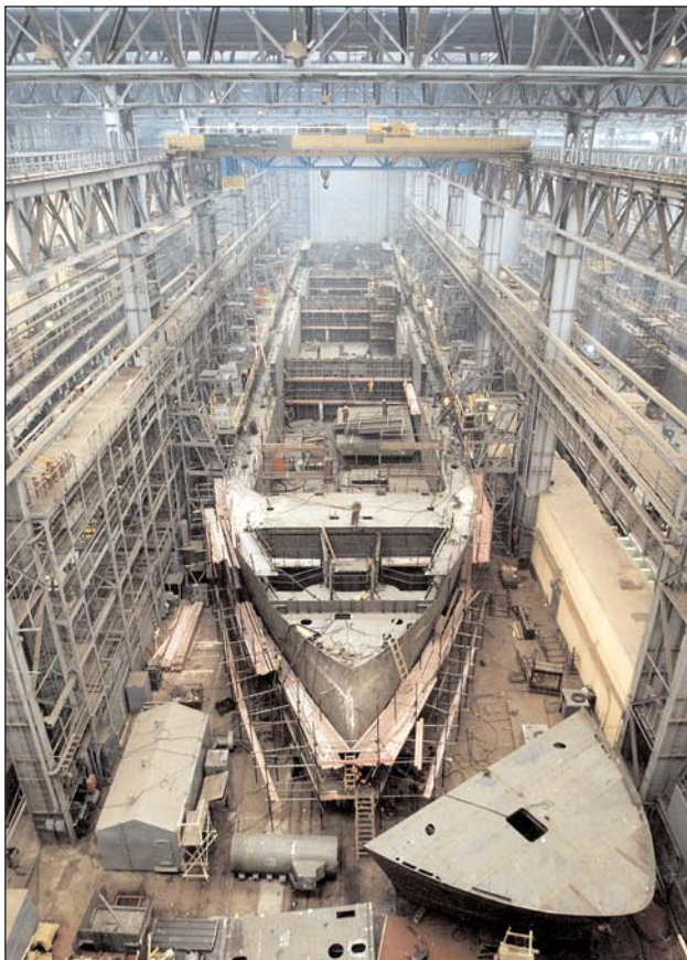
Постройка серийного универсального сухогруза типа «Валдай» в эллинге ОАО СЗ «Северная верфь»
