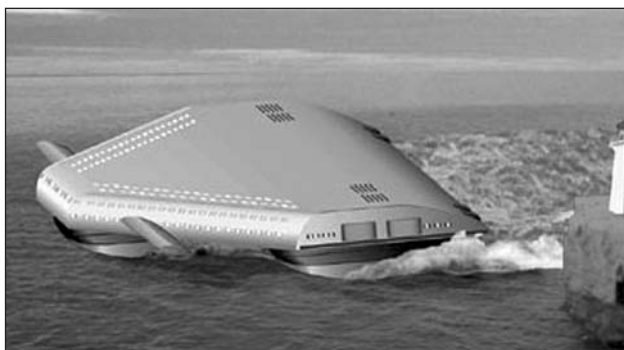
Сверхскоростной «рассекающий волны» тримаран-полужанкоплан: пассажироместимость 1000 чел., скорость 100 уз на тихой воде, при волнении 5 бал — 60 уз
