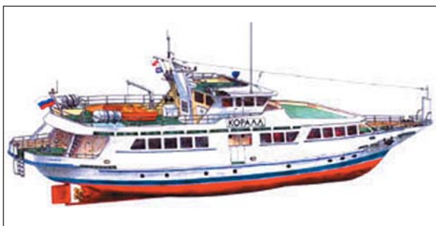
Проектное изображение прогулочного теплохода «Коралл» (ЗАО «Минибот»). Основные характеристики: размеры 30,4/24,2х5,35х2,8 м, осадка порожнем 1,93 м, водоизмещение порожнем 109,6 т (максимальные — 2,07 м и 122 т), мощность ГД 220 кВт, скорость 20 км/ч, автономность 3 сут, пассажироместимость от 12 до 56 чел.
