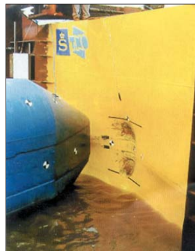
Баржа-газовоз «Chemgas 20»; патентованная «противоударная» конструкция ее корпуса; результат натурных испытаний корпусной секции после удара бульбом реального судна
