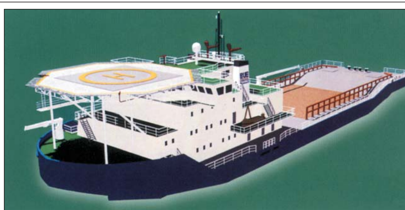
Норвежская верфь Ulstein Verft строит ледокольное судно снабжения для шотландской компании BUE Marine. Оно будет снабжено двумя винторулевыми колонками Schottel SRP2020 (2 x 2000 кВт/1194 об/мин) и двумя типа 220T Pump-Jets (2 x 850 кВт). Проект разработан фирмой BMT Shipdesign, класс судна DNV + 1A1 Supply Vessel. EO. Ice 1A*F. Планируется, что судно будет эксплуатироваться нефтяным консорциумом в Каспийском море
