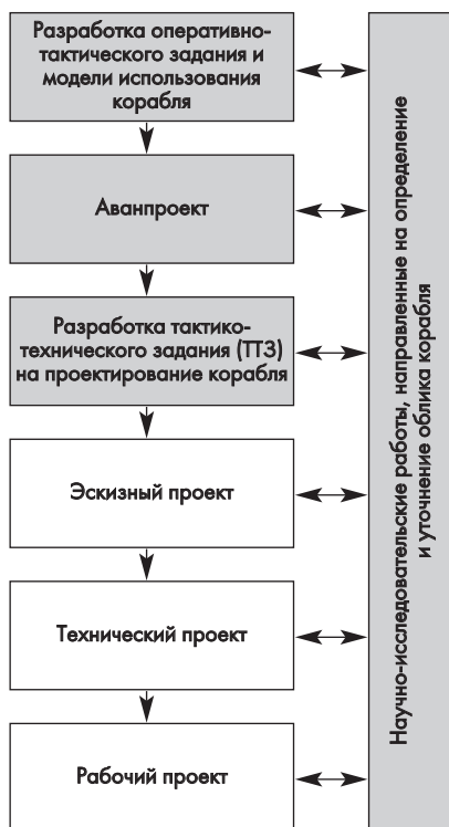
Рис. 1. Стадии проектирования корабля
