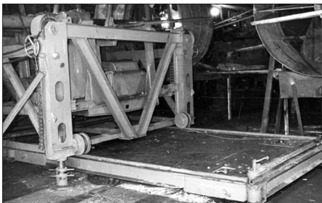
Рис. 4. Расточка кронштейна гребного вала
