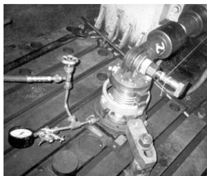
Ресурсные испытания на поворот ( \pm 3^\circ ) сифонного компенсатора шарнирно-поворотного типа
