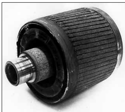
Ротор с подвижной втулкой из стали ДИ48-ВД и протекторной втулкой из сплава АМг-3М электродвигателя типа АМВ-3 после ресурсных испытаний
