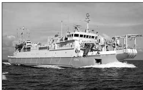
Рис. 1. Малое кабельное судно «Кемь» (пр. 1122) водоизмещением 2145 т постройки 1980 г.
