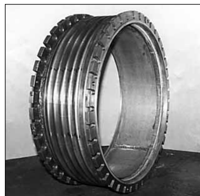
Рис. 2. Сильфонный компенсатор осевого типа D_{вн} 1160 мм, P_y 1, предназначенный для компенсации деформаций между главной паротурбинной установкой и главным холодильником
