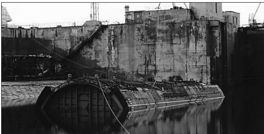
Трехотсечный блок утилизируемой по технологии НИПТБ «Онега» атомной подводной лодки на стапеле и на плаву
