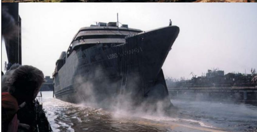
Автомобильно-пассажирский паром «Lobo Marinho 1» — плод сотрудничества ОАО «Балтийский завод» и португальской верфи ENVC. Основные элементы и характеристики: длина 112 м, ширина 20 м, максимальная осадка 4,7 м, дедвейт 1100 т, скорость 21 уз, число пассажиров и команда — 1200 чел., автомобилемместимость 145 шт.
