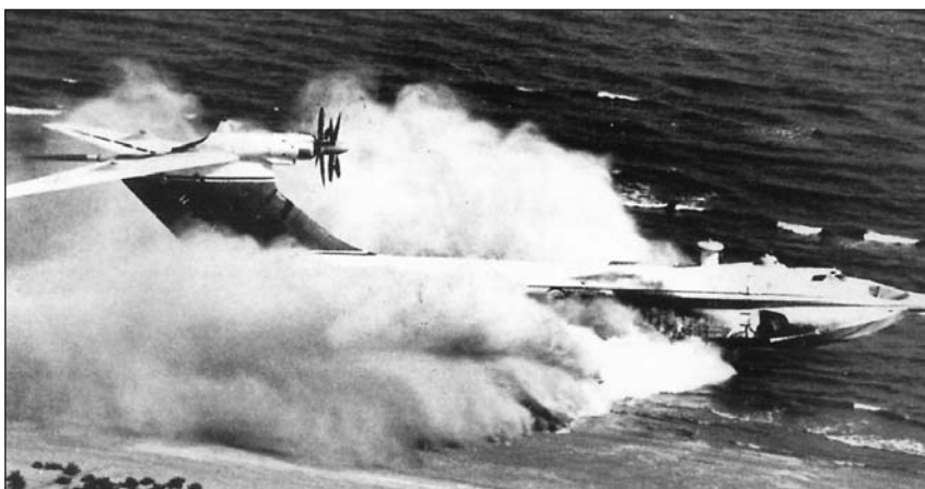
Поддув под крыло обеспечивает самостоятельный сход с суши
