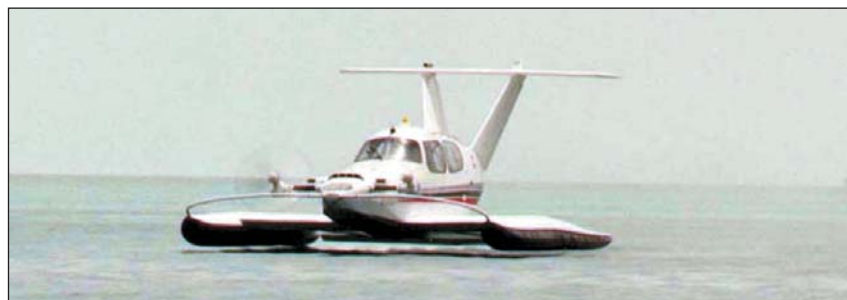
Экраноплан в движении с использованием экранного эффекта
