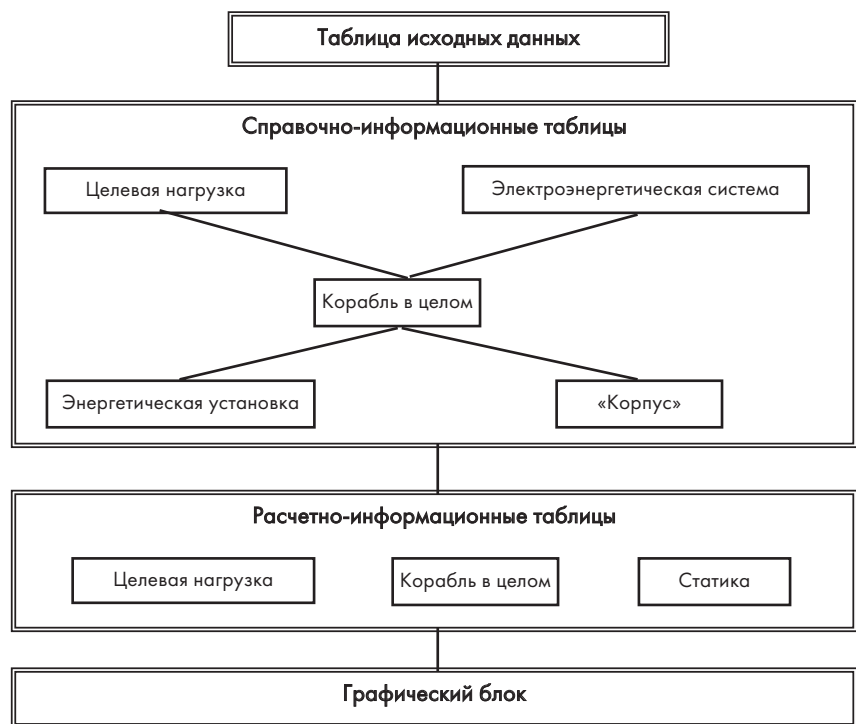
Рис. 2. Структура базового расчетного блока САПР «Судно»
