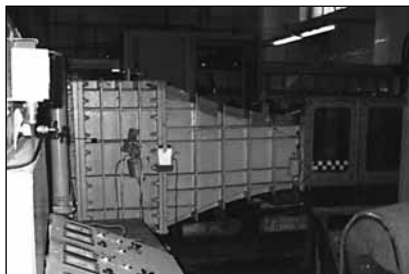
Рис. 3. Рабочий участок проведения экспериментов (гидролоток)
