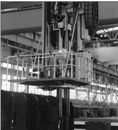
Специализированная установка PEMA VWS для автоматической сварки вертикальных соединений корпусных конструкций двойного дна
