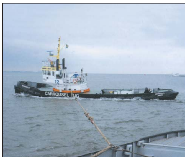
Голландский буксир «Multratug 12» с «карусельной» системой крепления буксирного каната
