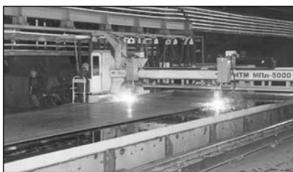
Широкопортальная машина тепловой плазменной резки «Ритм», разработанная и изготовленная в ЦНИИТС
