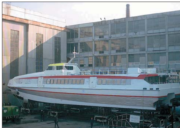
Паром в ходе постройки в эллинге ОАО МЗ «Алмаз» и после вывода из него для спуска на воду
