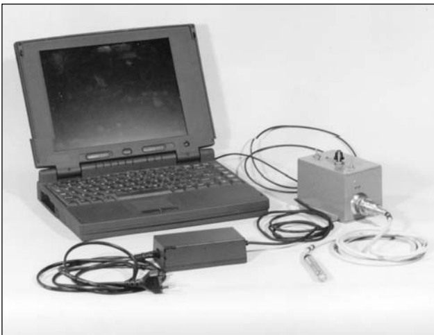
Рис. 1. Опытный образец анализатора акустических полей сквозных микронеплотностей
