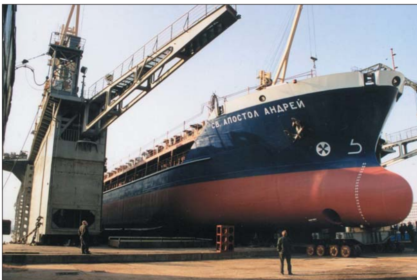
Сухогруз «Св. апостол Андрей» в процессе перевода в плавучий док для спуска на воду
