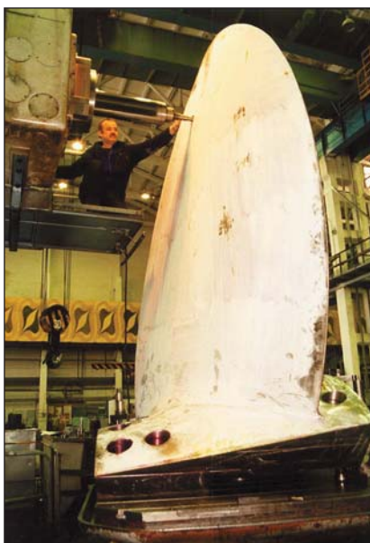
Лопасть гребного винта для проекта «Фортум» в цехе ФГУП ПМ «Звездочка»
