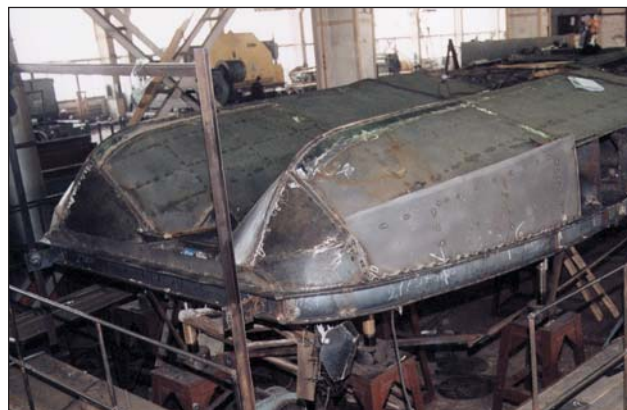
Формирование корпуса пассажирского судна типа «Кержак» в эллинге
