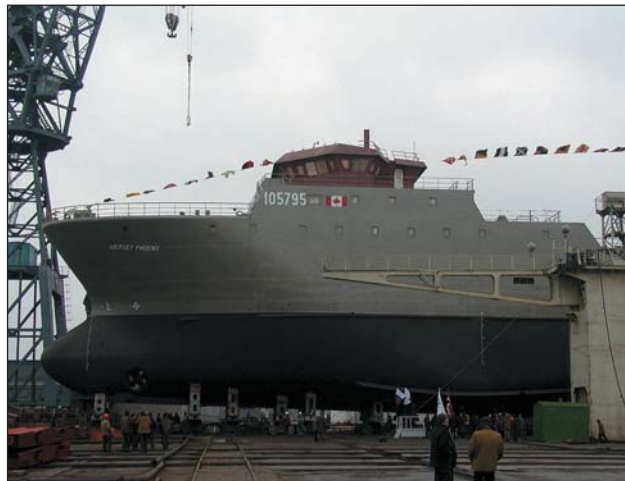
Передвижка арктического траулера «Mersey Phoenix» в плавучий док ОАО ПСЗ «Янтарь» для последующего спуска на воду
