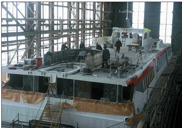
Паром в ходе постройки в эллинге ОАО МЗ «Алмаз» и после вывода из него для спуска на воду
