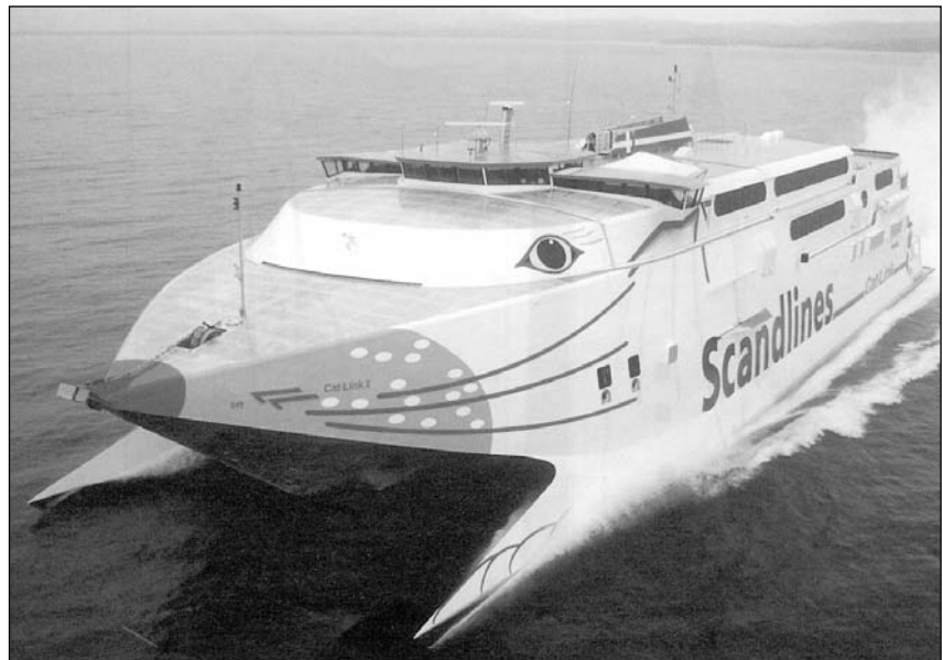
«Catlink V» — скоростной 91,3-метровый автомобильно-пассажирский паром-«волно-прорезатель», построенный австралийской верфью Incat Australia, развивает эксплуатационную скорость 43 уз
