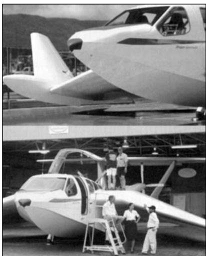
Экраноплан FS8, рассчитанный на шесть пассажиров, проходит испытания в Австралии
