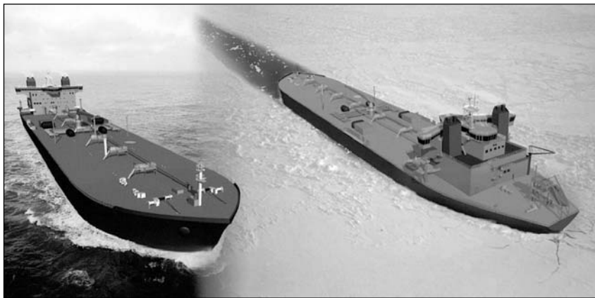
Кваerner Masa-Yards разработала и запатентовала концепцию танкера «двойного действия» (DAT — Double Acting Tanker). Два танкера этого типа дедеветом по 106 900 т должны быть построены японской верфью Sumitomo Heavy Industries в 2002 г. для компании Fortum Oil and Gas
