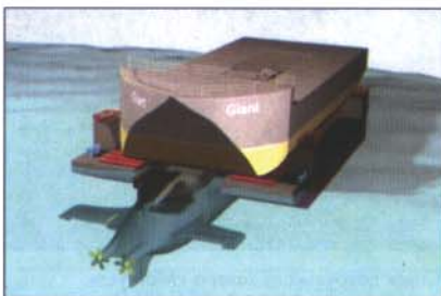
Понтоны «Гоп» и «Маг» и схема их установки перед докованием АПЛ «Курск»
