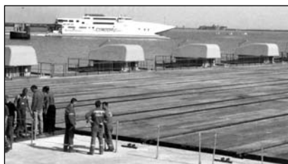
Платформа нового вертикального судоподъемника Synrolift в Шербуре имеет ширину (32 м), обеспечивающую докование паромов-катамаранов
