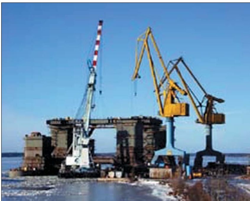
Постройка многоцелевой полупогружной платформы CS-50 для норвежского заказчика на акватории ОАО «Выборгский судостроительный завод» ( www.vyborgshipyard.ru )
