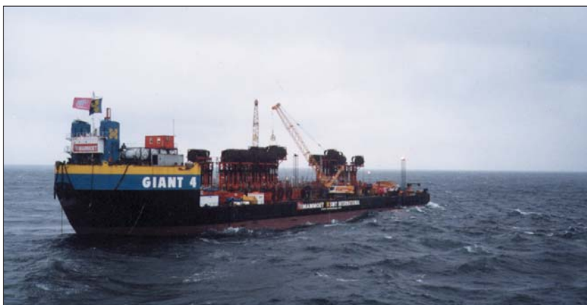
Рис. 8. Баржа «Giant 4» с подъемной грузонесущей системой во время работ над АПЛ
