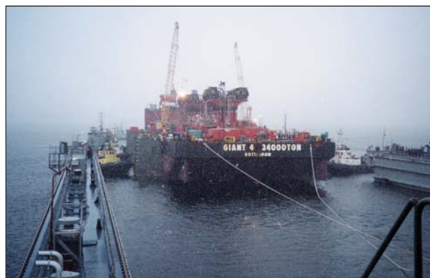
Рис. 15. Заведение системы «баржа—АПЛ—понтон» в док ПД-50
