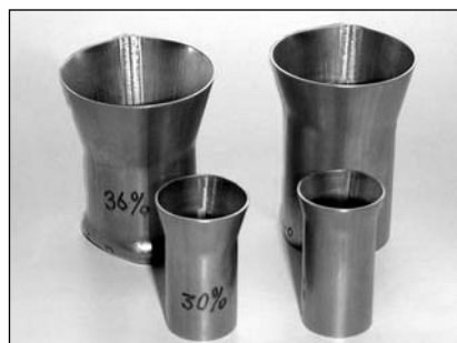
Рис. 2. Образцы после испытания на раздачу
