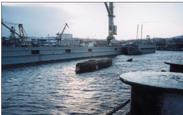
Рис. 16. Всплытие дока ПД-50 вместе с АПЛ «Курск». Слева видно ограждение выдвижных устройств, справа — верхняя часть корпуса лодки с технологическими вырезами, выполненными при подводно-технических работах
