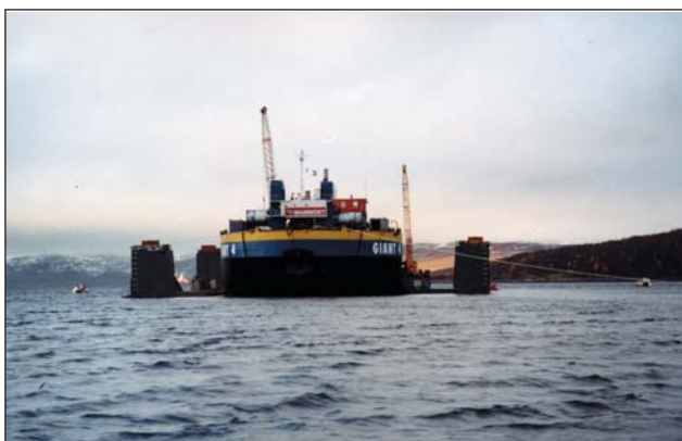
Рис. 14. Баржа с прижатой к ее днищу АПЛ и подведенными понтонами дополнительной плавучести в Кольском заливе
