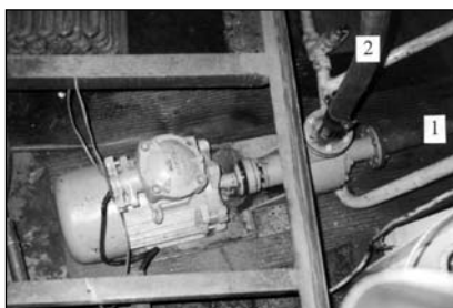
Рис. 3. Общий вид РПСД-1,5 при работе: 1 — магистраль подвода обрабатываемой среды; 2 — дюритовый шланг для отвода ВТС
