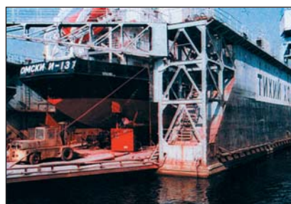
Доковый ремонт сухогруза «Омский-137» дедвейтом 3029 т в плавдоке ОАО «РЭБ флота» в Санкт-Петербурге
