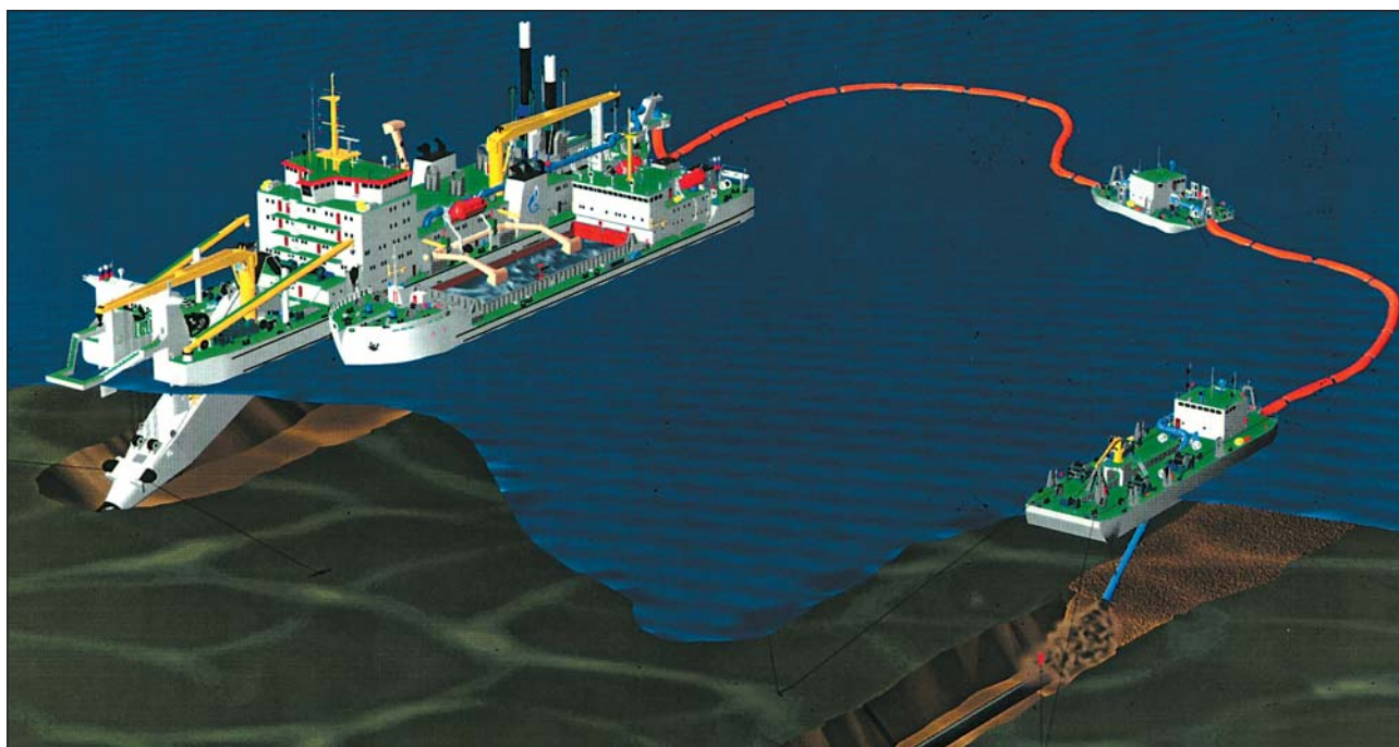
Комплекс плавучих технических средств для дноуглубительных работ на шельфе арктических морей разработан ОАО «ЦКБ «Лазурит»
