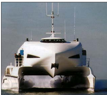
Скоростной катамаран «Iris 6.1» со съемными модульными пассажирскими/грузовыми блоками
