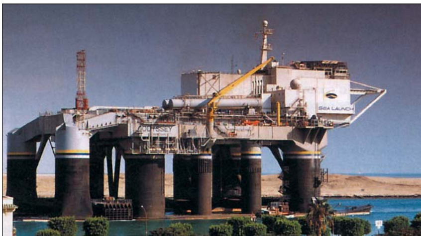
Стартовая платформа «Odyssey» для морских запусков спутников из экваториальных районов
