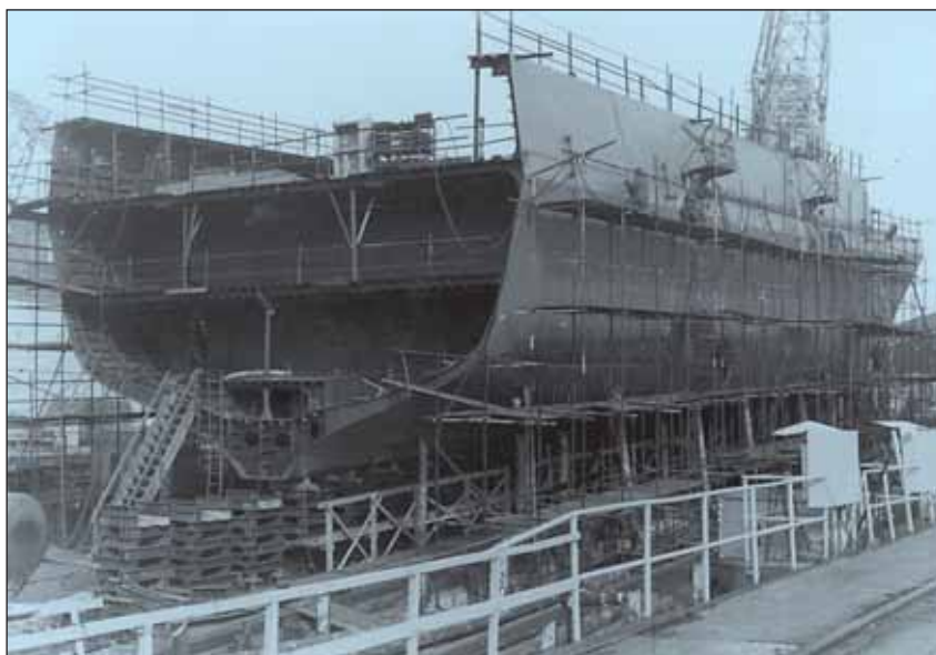
Формирование корпуса фрегата пр. 11356 на Восточном стапеле ОАО «Балтийский завод» (фото А. Ф. Герасимова)
