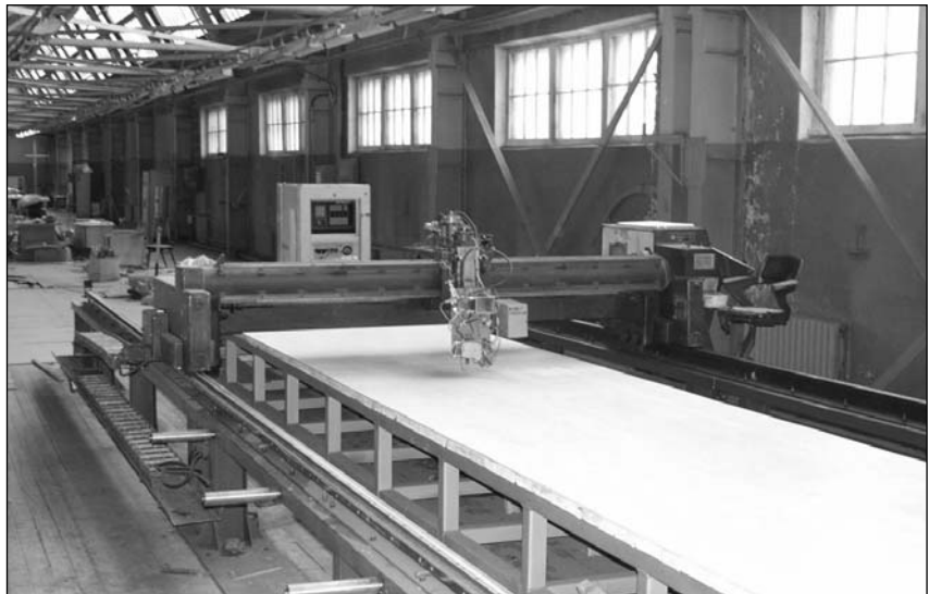
Рис. 1. Машина с ЧПУ для вычерчивания гибочных шаблонов, изготовленная на базе МТР «Кристалл»
