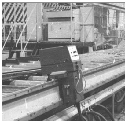
Рис. 3. Разметочная машина с ЧПУ «Стрела» для нанесения на стенку профильных заготовок графических шаблонов (разработка ЦНИИТС)
