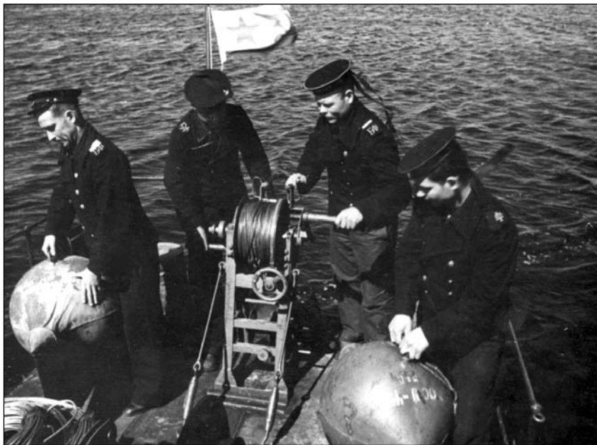
Подготовка трала к постановке
