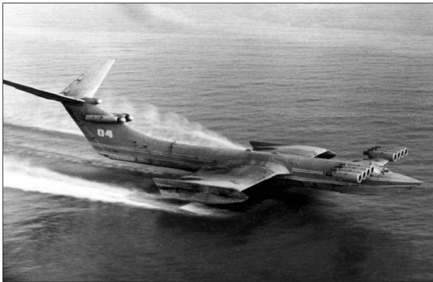
Самый большой в мире 500-тонный экспериментальный экраноплан КМ длиной 92 м, построенный Р. Е. Алексеевым в 1965 г., развивал полетную скорость на экране 400–450 км/ч
