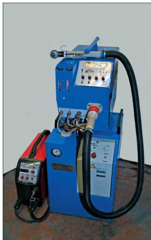
Рис. 1. Общий вид опытного образца полуавтомата ППН-200
