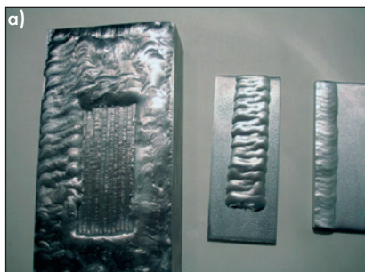
Рис. 4. Образцы механизированной плазменной наплавки: а — сплава АМг-61; б — стали 12Х18Н10Т
