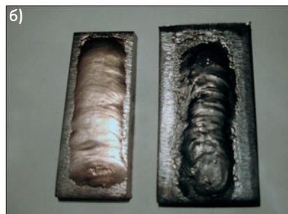
Рис. 4. Образцы механизированной плазменной наплавки: а — сплава АМг-61; б — стали 12Х18Н10Т
