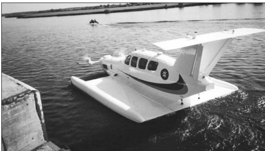
Малый пассажирский экраноплан «АкваГлайд-5», сертифицированный РС (ЗАО АТК). Взлетная масса 2,4 т, скорость 170 км/ч
