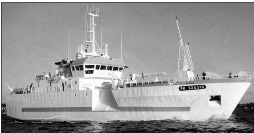
Французское судно-ярусолов, предназначенное для глубоководного промысла в Индийском океане, имеет необычное расположение слипа — в районе миделя
