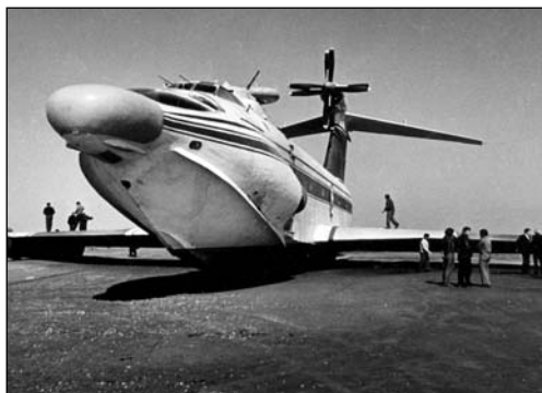
Десантный экраноплан «Орленок». Взлетная масса 140 т, скорость около 350 км/ч
