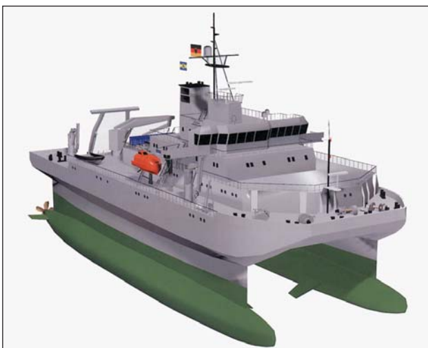
Научно-исследовательское судно с малой площадью ватерлинии (SWATH—Small Water Area Twin Hull) для ВМС ФРГ строится на верфи Nordseewerke GmbH. Основные элементы и характеристики: длина 73 м, максимальная ширина 27,2 м, осадка 6,8 м, водоизмещение 3500 т, суммарная мощность двух двигателей 4500 кВт, скорость 15 уз, дальность плавания 5000 миль, автономность 30 сут, экипаж 25 чел., научные работники — 20 чел.
