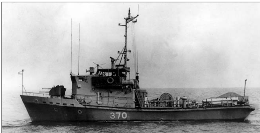
Первый отечественный рейдовый тральщик с корпусом из стеклопластика (пр. 1258)
