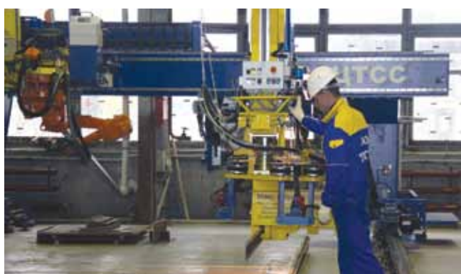
Захват ребра жесткости манипулятором
