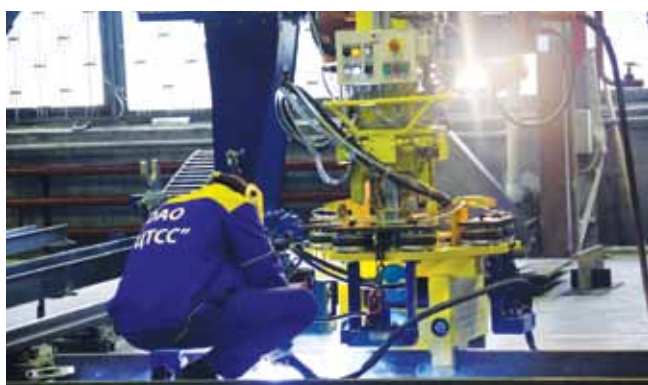
Прихватка ребра к полотну микропанели
