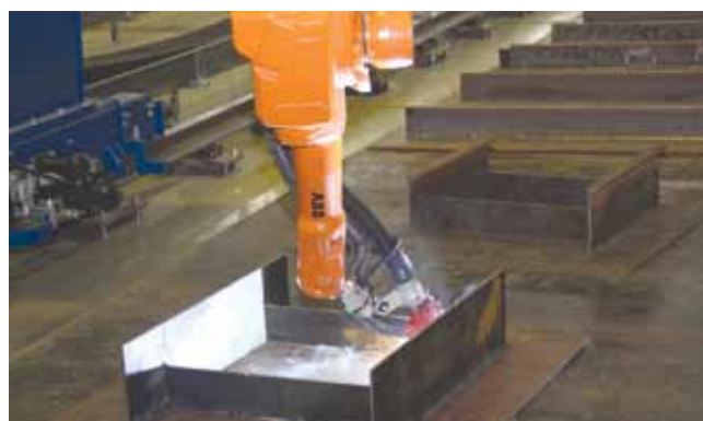
Вертикальная и горизонтальная приварка ребер жесткости к микропанели сварочным роботом
