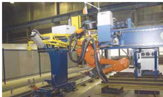
Портал для лазерного сканирования, фотограмметрирования и роботизированной приварки ребер жесткости микропанелей
